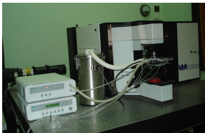
Hình 2.3. Bố trí thí nghiệm khảo sát sự phụ thuộc phổ PL vào nhiệt độ khi sử dụng phổ kế LABRAM-1B và thiết bị Linkam THMS 600.
